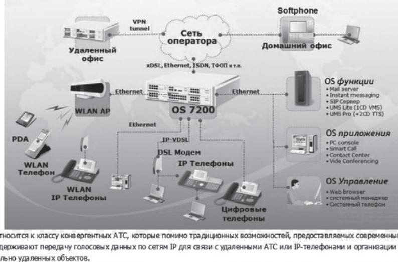
Система Officeserv 7200 относится к классу конвергентных АТС, которые помимо традиционных возможностей, предоставляемых современными цифровыми АТС с коммутацией каналов поддерживают передачу голосовых данных по сетям IP для связи с удаленными АТС или IP-телефонами и организации единой системы связи в сети из нескольких территориально удаленных объектов.
