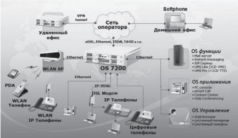
Система OfficeServ 7200 относится к классу конвергентных АТС, которые помимо традиционных возможностей, предоставляемых современными цифровыми АТС с коммутацией каналов поддерживают передачу голосовых данных по сетям IP для связи с удаленными АТС или IP-телефонами и организации единой системы связи в сети из нескольких территориально удаленных объектов.
