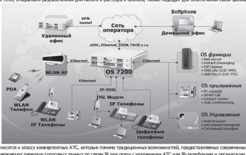
Система Officeserv 7200 относится к классу конвергентных АТС, которые помимо традиционных возможностей, предоставляемых современными цифровыми АТС с коммутацией каналов поддерживают передачу голосовых данных по сетям IP для связи с удаленными АТС или IP-телефонами и организации единой системы связи в сети из нескольких территориально удаленных объектов.
